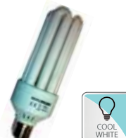
HYPUSU-3227CW (H154) 4U E27 32W 4200K, 220-240V, 50/60HZ, 2052LM, 8000H 180LONG, 60Ø
