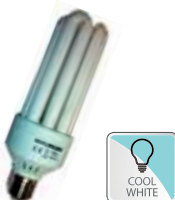
HYPUSU-3827CW (H155) 4U E27 38W 4200K, 220-240V, 50/60HZ, 2520LM, 8000H 240LONG, 72Ø
