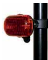
P3910 (E052) 3x LEDs rojos Ø 5 mm, 2x AAA, 1.5 V, 75h, 60x30x35 mm, pinza para sujeción
